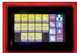
**IT**\_ Pannello Operatore Touch screen 7" Pannello operatore con 99 + 1 programmi di avvolgimento e selezione dei parametri quali: giri alti e bassi, velocità di rotazione, sovrapposizione film in salita ed in discesa, stop per top cover e programma con fermata programmata in altezza.
